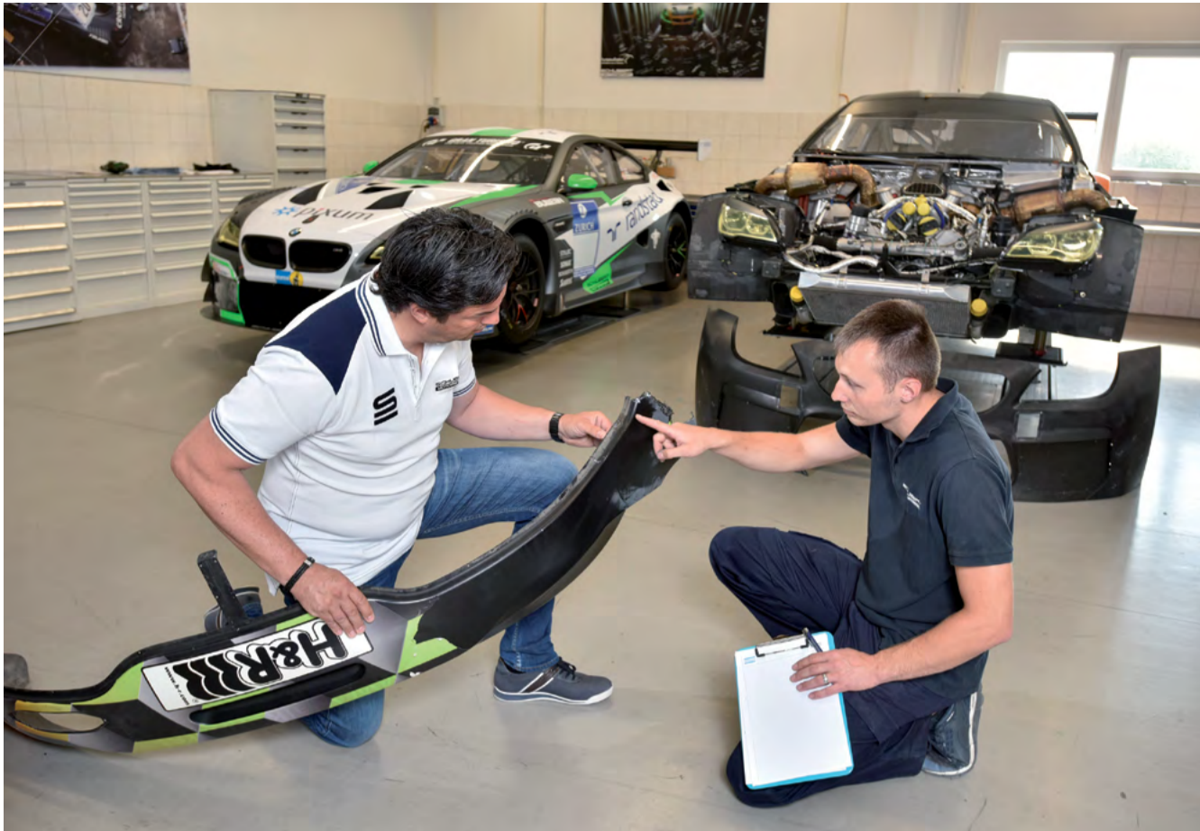
Teamleiter Frank Link (links) und Techniker Sebastian Gitte begutachten eine defekte Stoßstange, die sie mit einem Carbonfaserverbund reparieren müssen.
