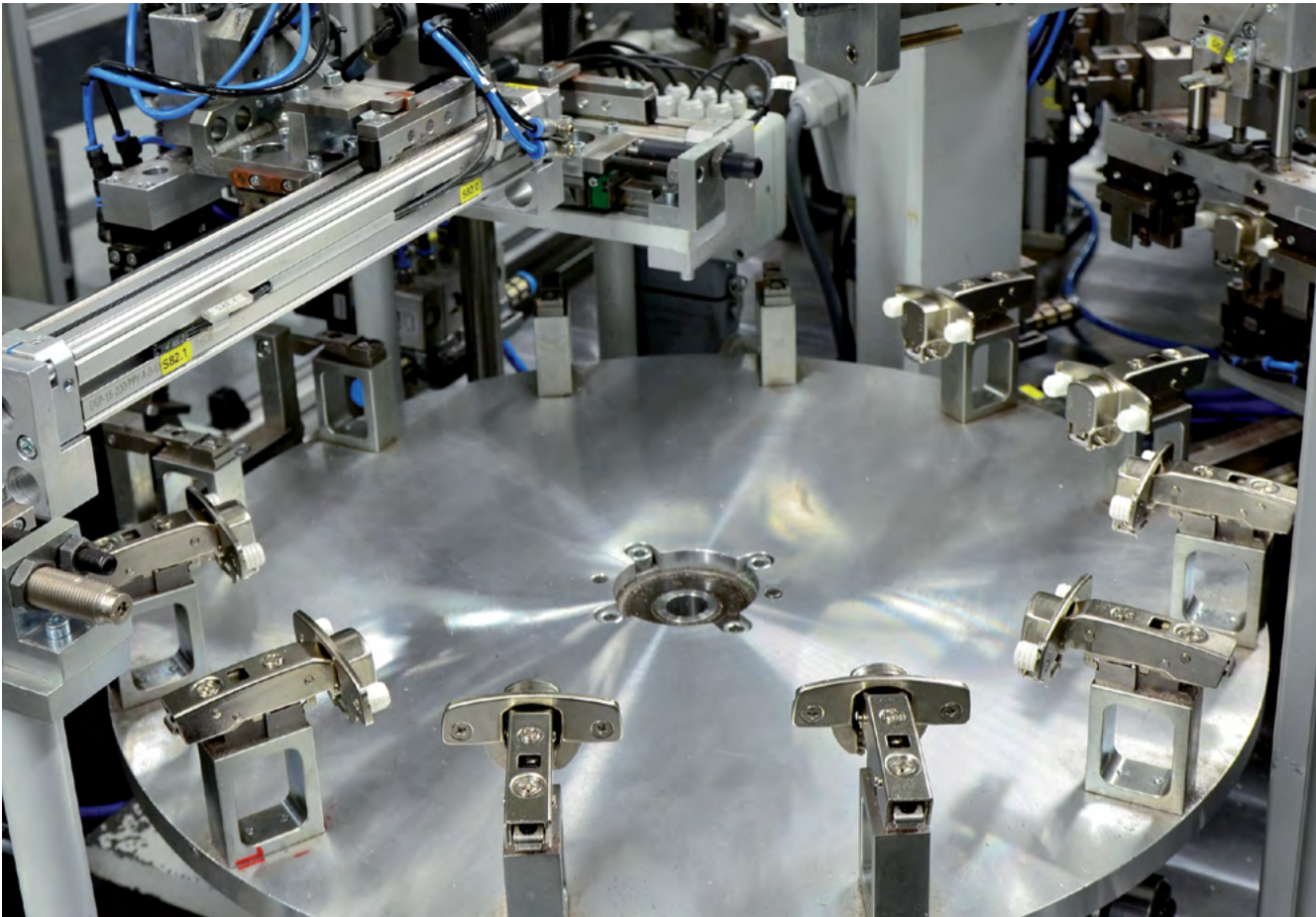
Rundschalttisch mit Scharnieren: Vollautomatisierte Montageprozesse ermöglichen eine hohe Fertigungskapazität.
