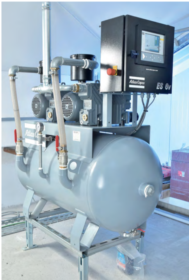
Die GVS-40-Doppelvakuumpumpe erzeugt bei Schubert genug Unterdruck für die Fertigung auch größerer Carbonteile.
