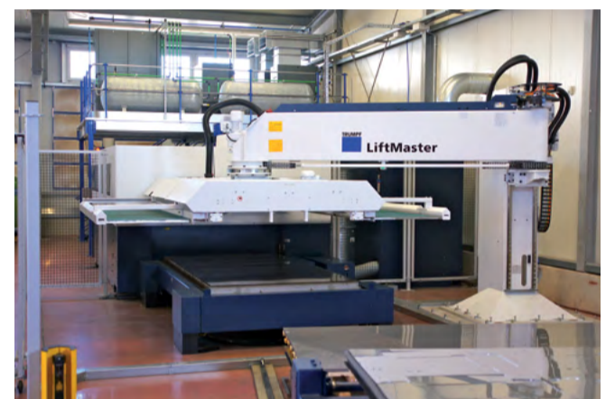
Die automatische Laserschneidmaschine benötigt neben technisch ölfreier Druckluft hochreinen Stickstoff der Klasse 5.0 mit einem Druck von 30 bar.
